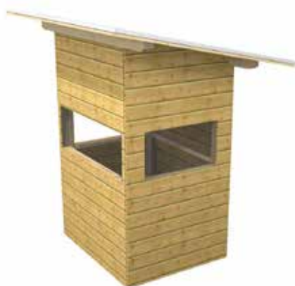
VERSION 2: JAGDKANZEL GRUND- KONSTRUKTION MIT FICHENSCHALUNG
