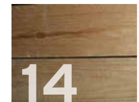
14 Rauschalung Breite: 150 mm Stärke: 24 mm
